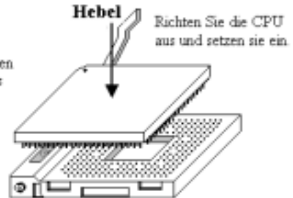
Abb. 3. Installieren Sie die CPU in Socket A
