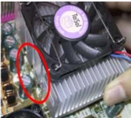
Figura 4. Installazione del dissipatore di calore
