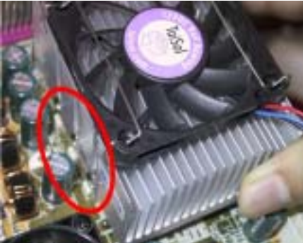
Abb. 4. Installation des Kühlkörpers
