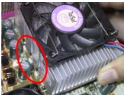
図 4. ヒートシンクの取り付け
