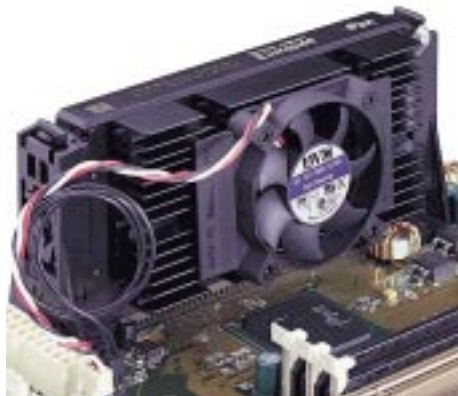
SECC Heatsink & Fan
