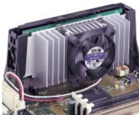
SECC2 Heatsink & Fan
