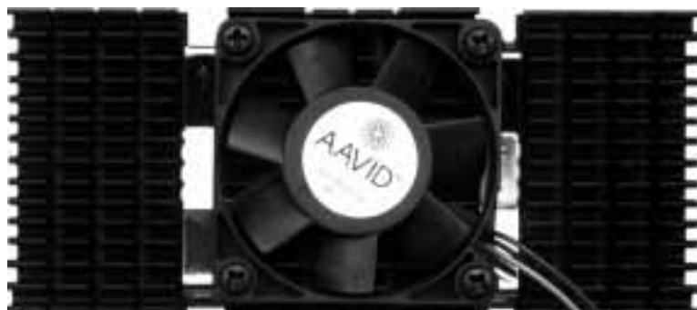
擁有風扇的 AAVID Pentium II 散熱片
