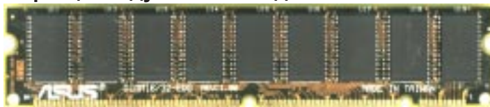
EDO DIMM-память с контролем четности (9 микросхем)
