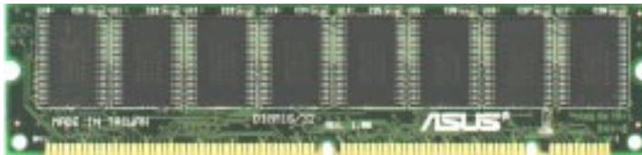
SDRAM DIMM-память без ECC (8 микросхем)
