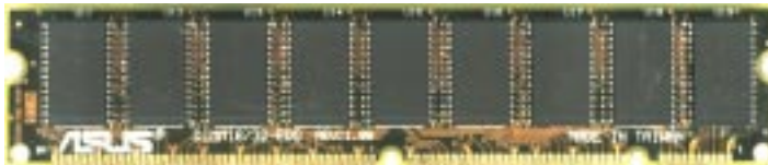
EDO DIMM-память с ECC (9 микросхем)
