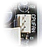
Anschluss des CPU-Lüfters
